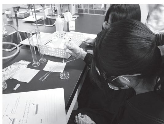
物質生命化学科： 水-油の界面を用いた超薄ナイロン合成の様子
